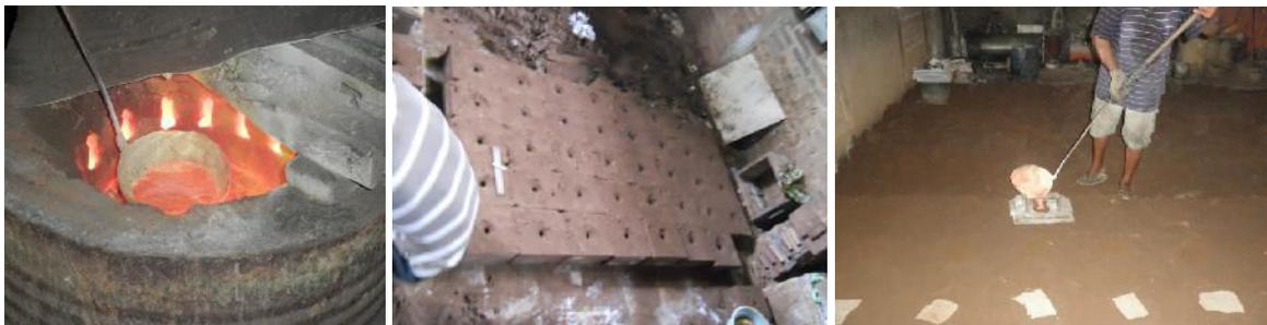
Gambar 4. Peleburan logam dan pengecoran dengan pasir cetak
