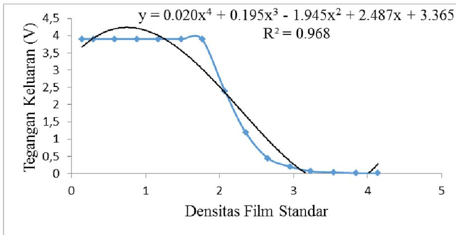
**Gambar 9. Respon Sensor Pada Rangkaian Densitometer**
