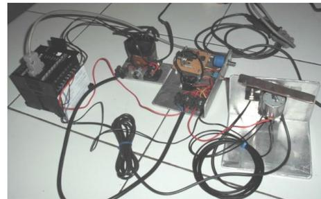
**Gambar 4** Rangkaian keseluruhan pengukur kecepatan motor DC berbasis PLC
