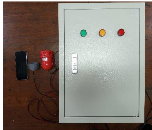
Gambar 5. Tampilan alat sistem peringatan dini banjir
