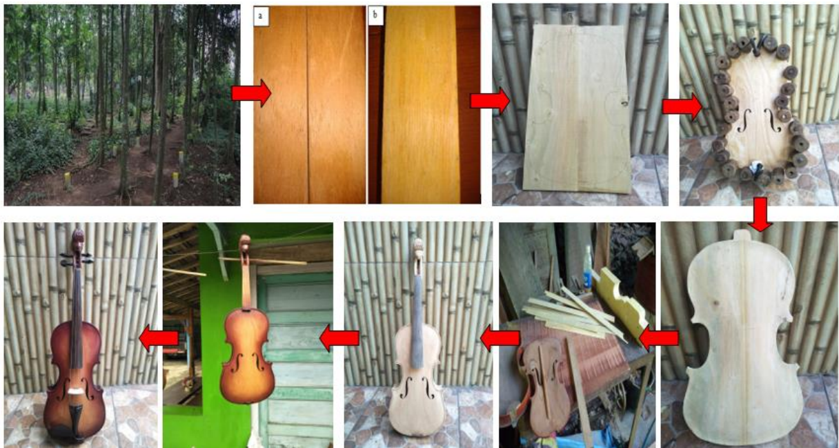
Gambar 4. Tahapan pembuatan alat musik modern jenis biola
