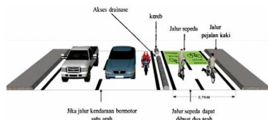
**Gambar 2.** Prespektif jalur sepeda dua arah tipe A dibadan jalan
