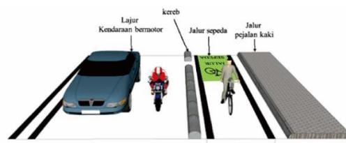
**Gambar 1.** Prespektif jalur sepeda satu arah tipe A dibadan jalan
