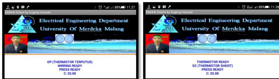
**Gambar 11. Tampilan pada smartphone android a=mencopot kabel dan b=mengkonsletkan kabel**
