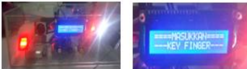
Gambar 13 Tampilan kondisi ketika end user telah ada, tetapi belum terdapat data sidik jari terhadap sensor fingerprint
