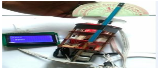
Gambar 4.3. Hasil pengujian mikrokontroler Atmega8 dengan sensor accelerometer.
