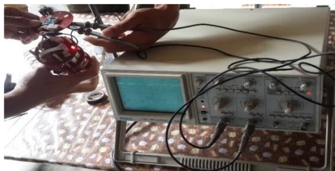
Gambar 4.1. Rangkaian pengujian sensor accelerometer ditampilkan dalam oscilloscope.
