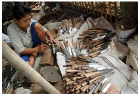
Gambar 2. Proses pemasangan gagang pisau dengan menggunakan bahan kayu
