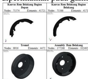
**Gambar 3.3** Hasil *meshing* masing-masing desain komponen rem belakang.
