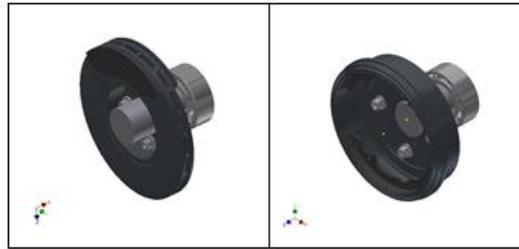
**Gambar 3.6 Desain *assembly dynamic simulation* rem depan dan belakang**
