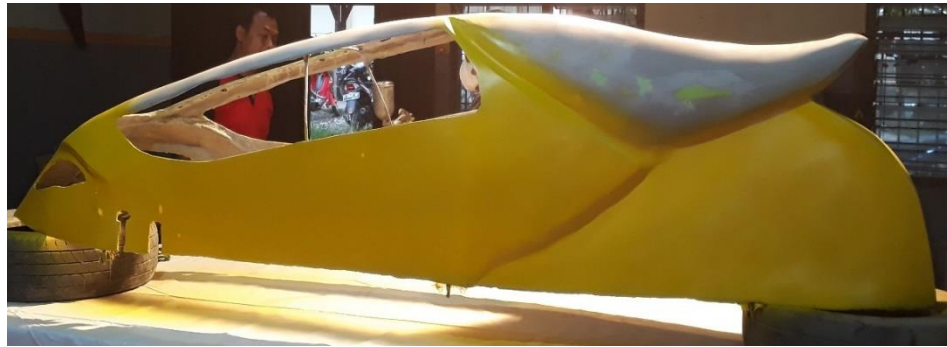
Gambar 5. Pekerjaan pengecatan dan finishing bodi
