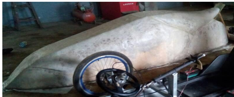
Gambar 4. Pembuatan bodi mobil listrik dengan fiberglass
