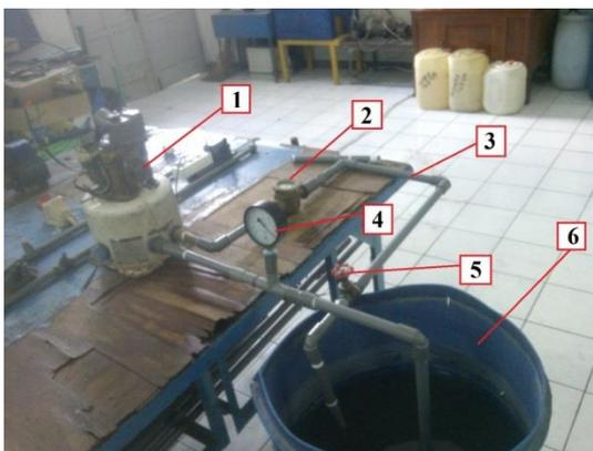
**Gambar 3. Rangkaian Pompa Sanyo Tunggal**
