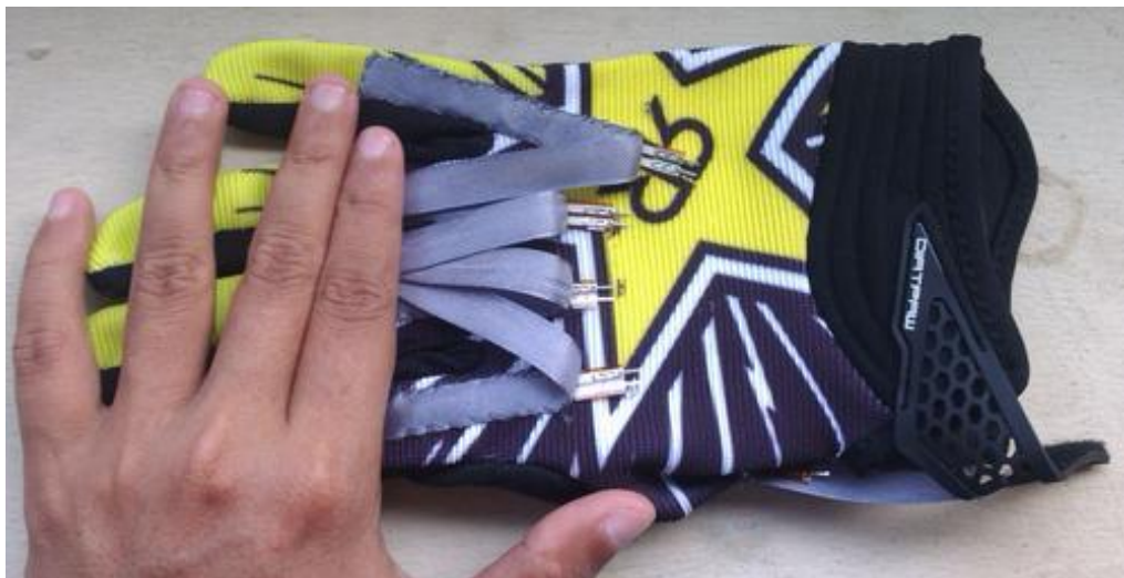
Gambar 9. Pemasangan Sensor Flex
