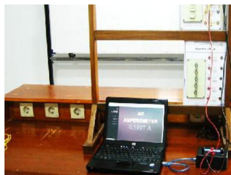
Gambar 4.2. Susunan Percobaan Menggunakan Instrumentasi Akuisisi Data.
