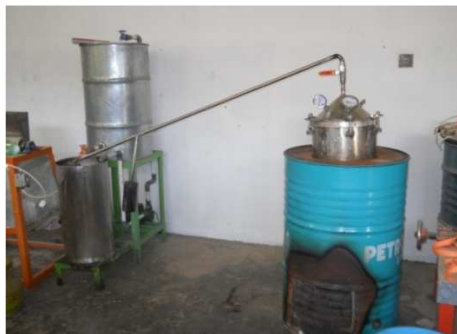
Gambar 2. Unit reaktor karbonisasi
