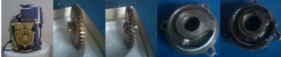
Gambar 1 Komponen Utama pompa sanyo, impeller sudu lurus, impeller sudu zig zag, tutup impeller cembung dan tutup impeller datar
