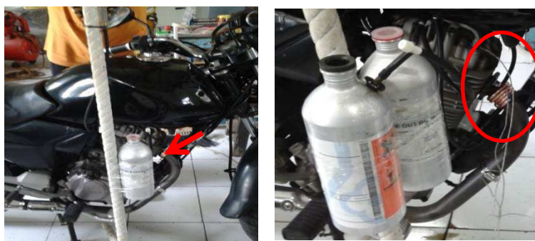
Gambar 1. Desain pipa spiral katalis HCS pada sepeda motor Honda Mega Pro
