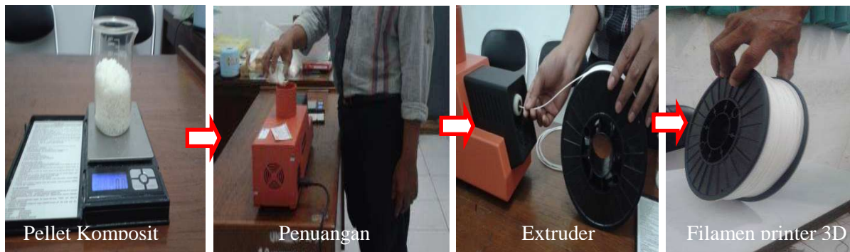
Gambar 2. Proses pembuatan filament biodegrasi print 3D
