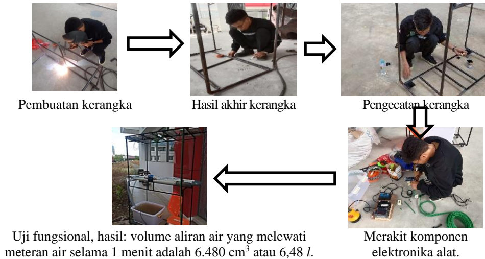
Gambar 3. Proses pembuatan dan uji fungsional sistem hidroponik berbasis photovoltaic
