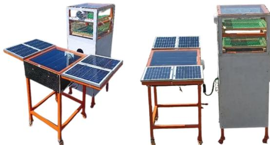
**Gambar 8.** Alat pengering cabai dengan sistem efek rumah kaca berbasis panel surya.
