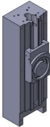
**Gambar 4. Assembly Pengarah Sumbu-Z**
