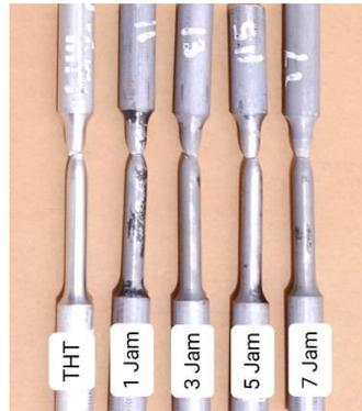
Gambar 2. Hasil pengujian Tarik pada specimen AA – 6061
