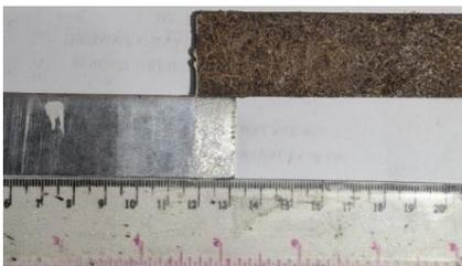
a) *Thin layer cohesive failure*
