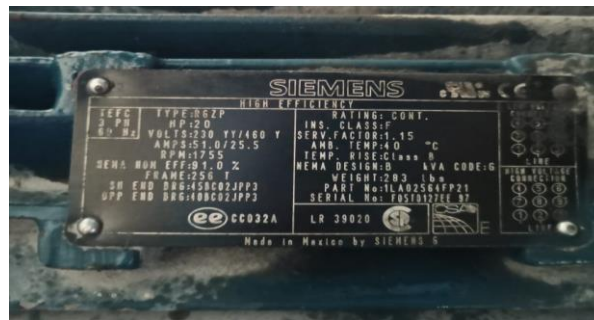
Gambar 4 Name Plate Motor Penggerak Draft Blower
