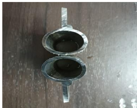
Gambar 8. Hasil Cutting Halus GMAW STKM13B Dan Plat SPH440.
