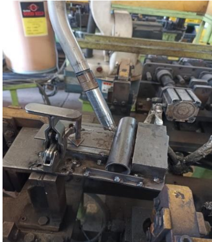
Gambar 4 Welding Jig untuk pengelasan pipa dan plat.
