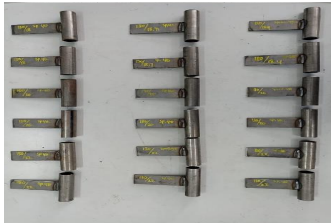
Gambar 6. Hasil Las GMAW material STKM13B dengan Plat SPH440.
