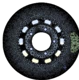
Gambar 5. Proses meshing pada pada dan piringan cakram
