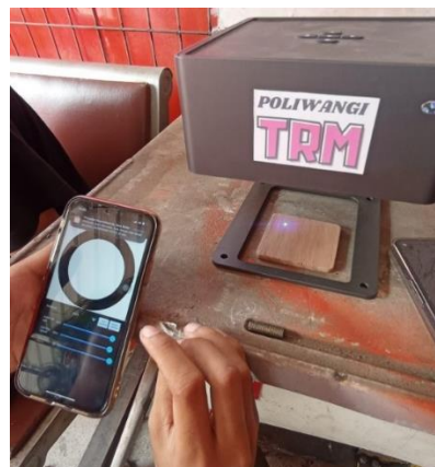
Gambar 5. Proses kalibrasi pada mesin dengan software engraving
