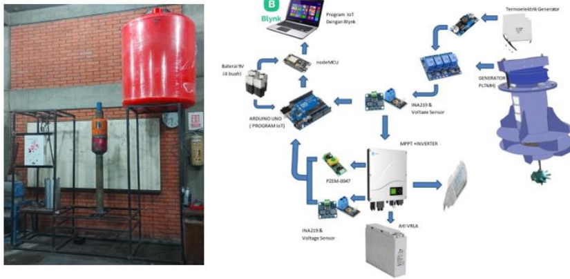
(a) Desain Prototipe pembangkit Hybrid PLTMH-TEG dan (b) sistem kerja pembangkit listrik hybrid (PLTMH-TEG)
