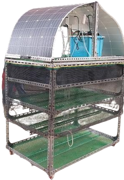
Gambar 3. Alat hidroponik untuk fodder jagung berbasis panel surya melengkung.
