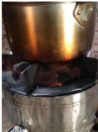
Gambar 4 Hasil nyala api 75% Tempurung kelapa, 25% serbuk kayu
