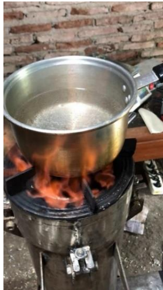
Gambar 6 Hasil nyala api 25% Tempurung kelapa, 75% serbuk kayu.
