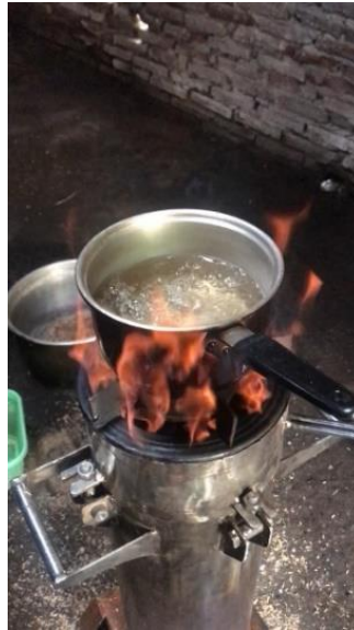
Gambar 5 Hasil nyala api 50% Tempurung kelapa, 50% serbuk kayu
