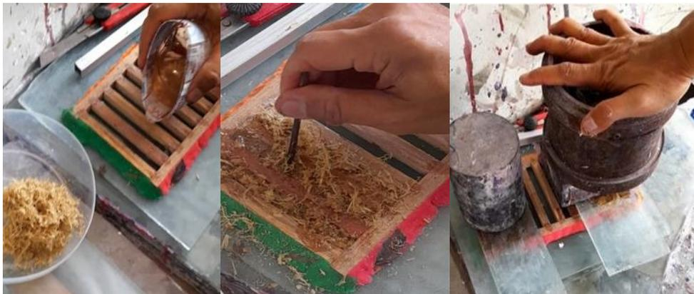
Gambar 4. Proses Penuangan Komposit pada Cetakan
