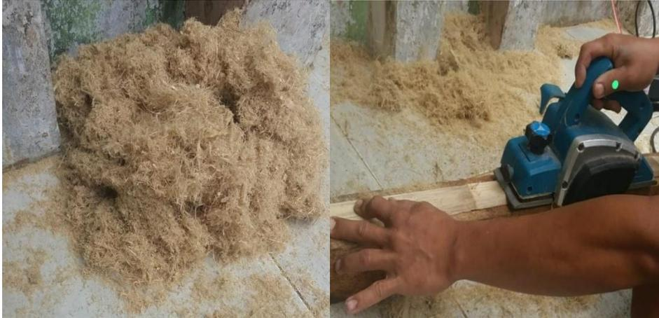
Gambar 2. Proses Pembuatan Serat Bambu Apus
