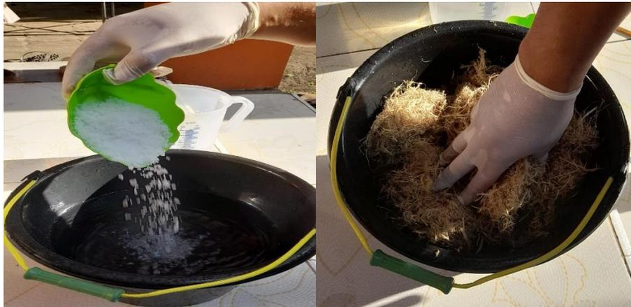
Gambar 3. Proses Ekstraksi Serat Bambu Apus dengan menggunakan NaOH
