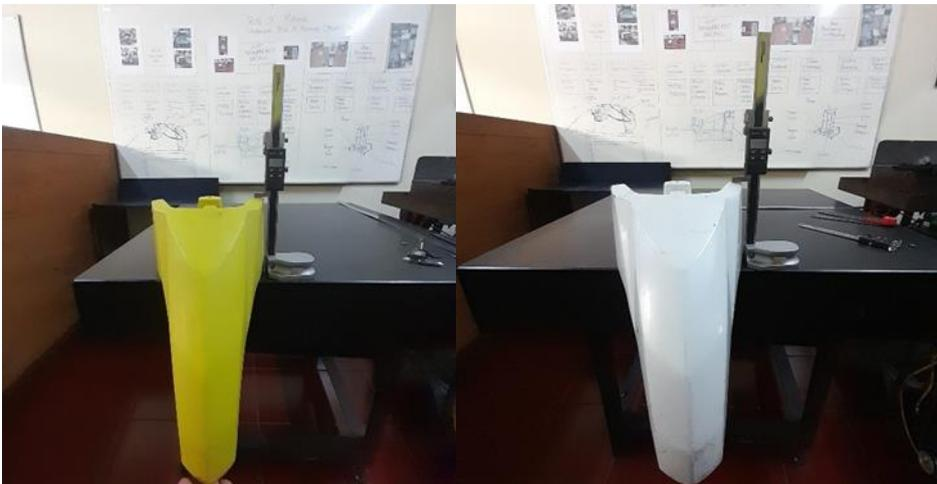
Gambar 13. Pengukuran Tinggi Spakbor
