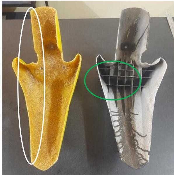
Gambar 10. Perbandingan Tampak Bawah Spakbor Komposit dengan Spakbor Pabrik
