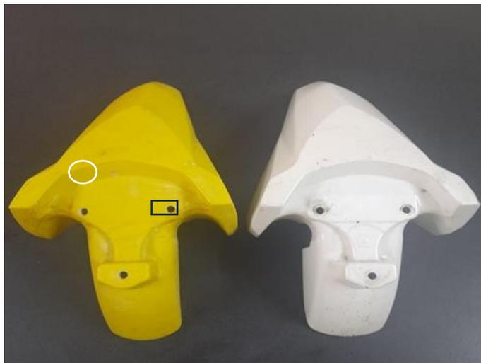
Gambar 8. Perbandingan Tampak Atas Spakbor Komposit dengan Spakbor Pabrikan
