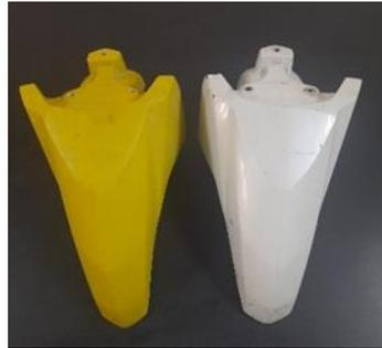
Gambar 7. Perbandingan Tampak Depan Spakbor Komposit dengan Spakbor Pabrikan
