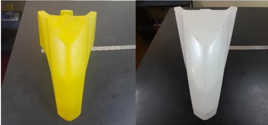
Gambar 12. Pengukuran Lebar Spakbor
