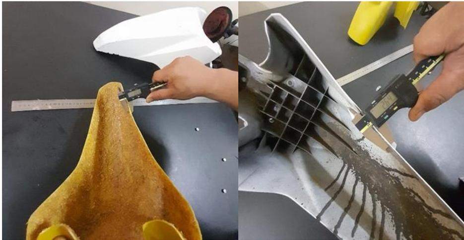
Gambar 14. Pengukuran Ketebalan Permukaan Spakbor
