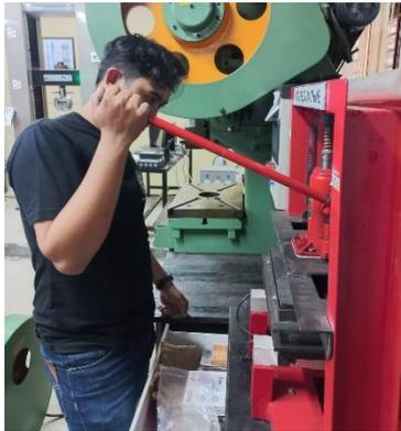
**Gambar 2.** Proses cetak komposit dengan *hot press*
