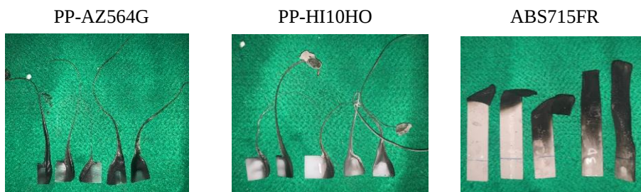
Gambar 3. Visualisasi setelah uji Flammability (tahan bakar)
