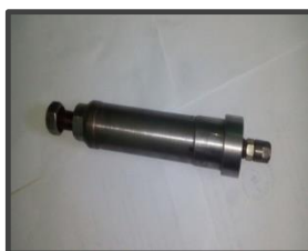
Gambar 3 alat pelepas dan pemasangan gear cam sprocket primer
