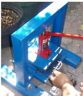
Gambar 1 Proses pengepresan briket
