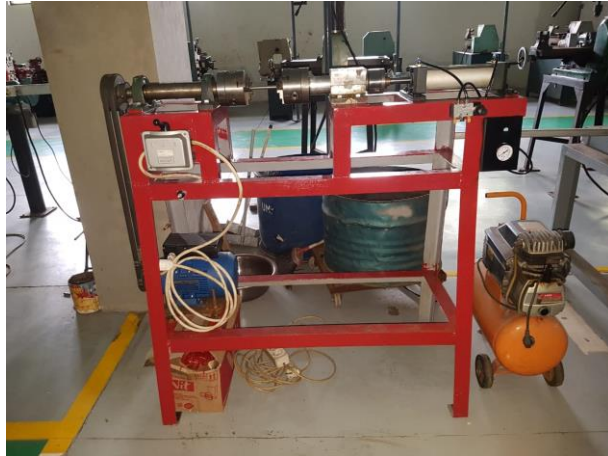
Gambar 14. Mesin las gesek dengan sistem pneumatik
