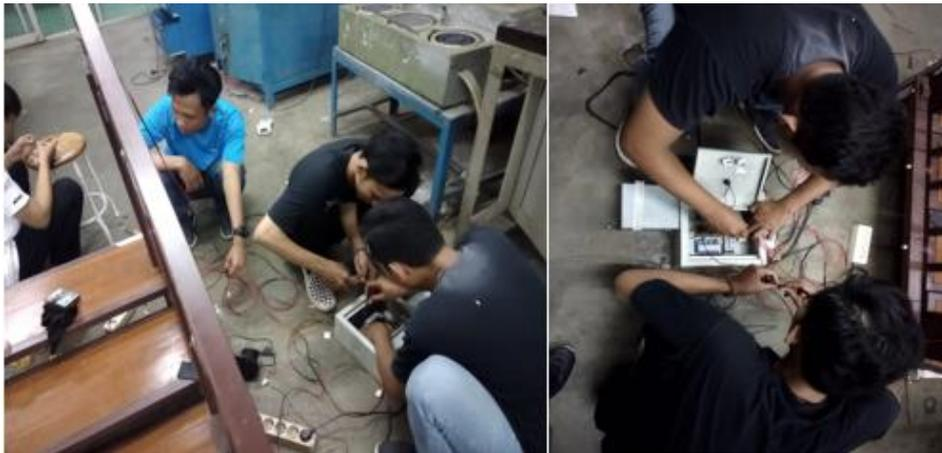
Gambar 6. Perakitan komponen *sistem kontrol Arduino UNO, relay, PCB rakit* kedalam *box control*.
