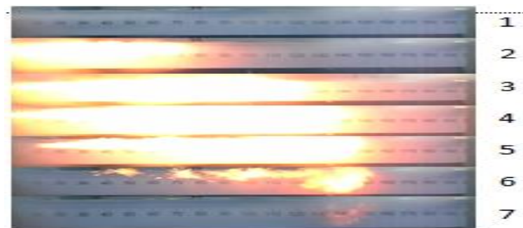
Gambar 11 : Visualisasi uji nyala minyak solar pada Tekanan 1900 Psi
