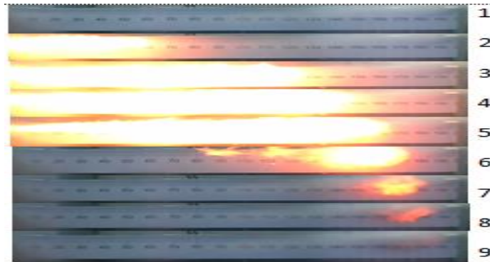
Gambar 8 : Visualisasi uji nyala minyak solar pada Tekanan 1300 Psi
