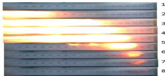
Gambar 9: Visualisasi uji nyala minyak solar pada Tekanan 1500 Psi
