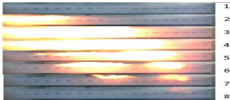
Gambar 10 : Visualisasi uji nyala minyak solar pada Tekanan 1700 Psi
