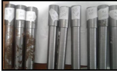
**Gambar 1 Bahan Spesimen Baja Karbon Medium**
