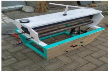
Gambar 2. Mesin Rolling Bending Akrilik
