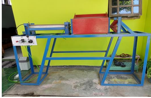
Gambar 2 mesin pembelah bambu dengan sistem pneumatic
