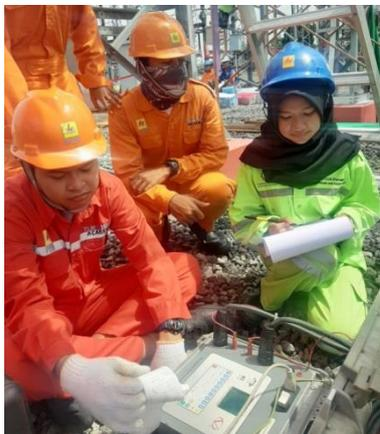
**Gambar 7. Pengujian tahanan kontak PMS**
