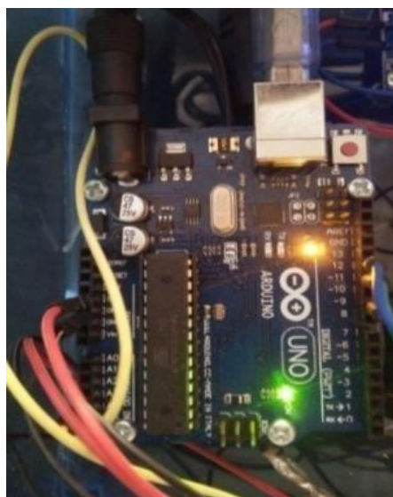
Gambar 11. Tampilan Pemasangan board arduino uno
