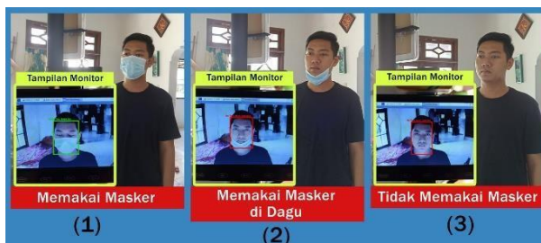
Gambar 7. Pengujian pembacaan camera terhadap objek
