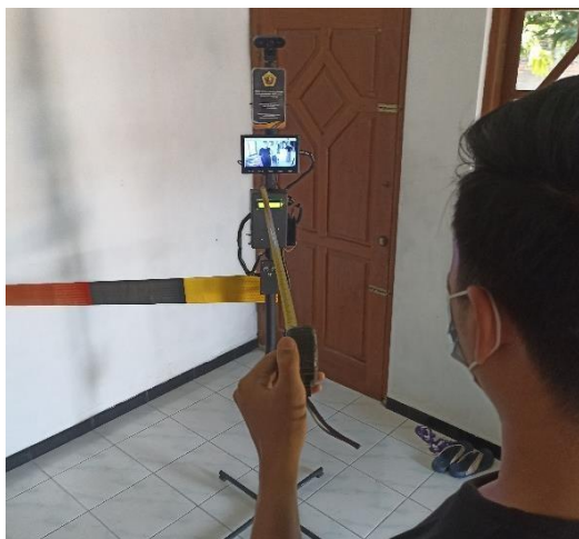
Gambar 8. Pengujian Jarak pembacaan camera terhadap objek
