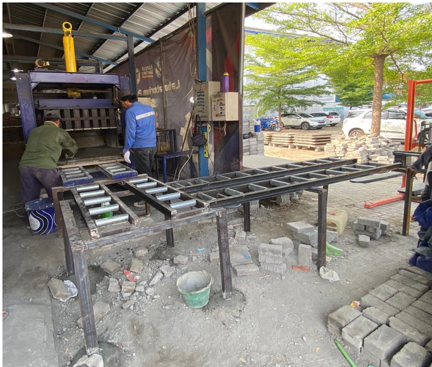
Gambar 5. Pemasangan Alat Bantu Kerja Meja Slider
