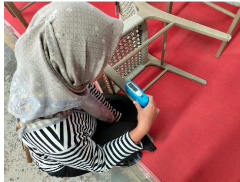
Gambar 7. Mengukur Tingkat Kilau Finishing
