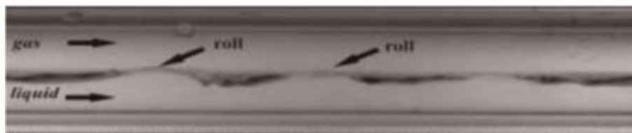
Gambar 8. Contoh Visualisasi Aliran Stratified Roll ( J_L = 0,050 m/s, J_G = 4,140 m/s, dan \phi = 19 mm ) Mahadiputra dkk., (2019)
