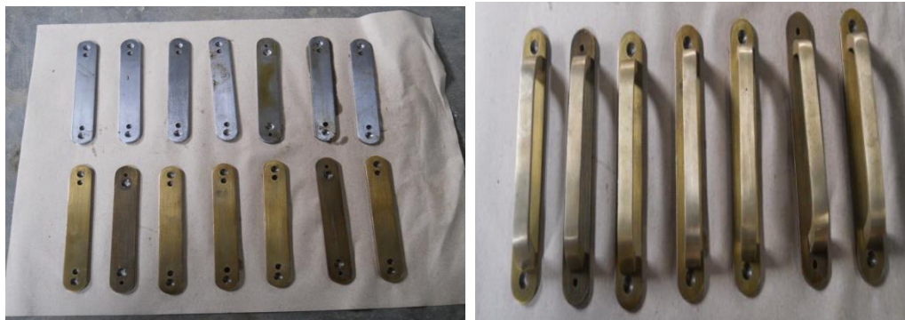
Gambar 7. Hasil produk handel pintu dari teknik elektroplating
