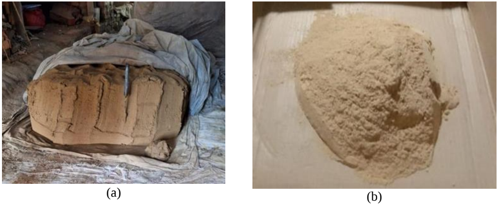
Gambar 2. Bahan membran keramik (a) tanah liat (b) mesh serbuk kayu
